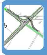
Südvariante 6 mit einseitigem Anschluss von Norden, Verlegung der St 2325 auf die Makofener Straße
